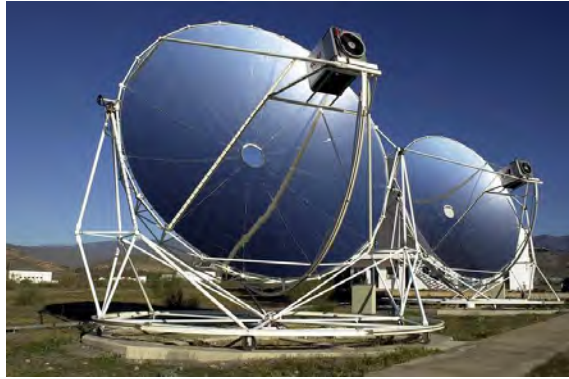
Figura 12. Colectores solares de alta concentración, desarrollados en la PSA.
