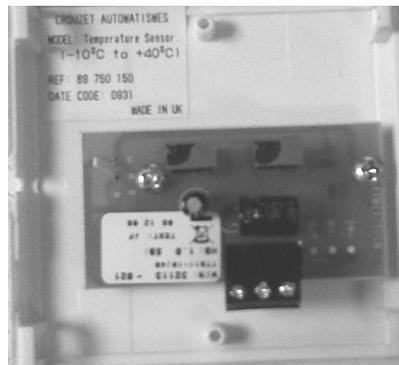
Figura 23. Termostato electrónico Crowzet 89 750 150
