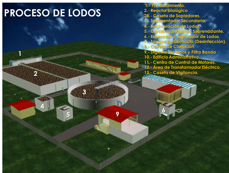
Figura 7. Estructuras que intervienen en el proceso para el manejo de lodos.
