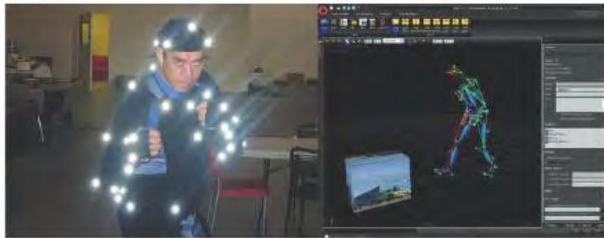
Figura 2. 6 Captura de movimiento con sistema basado en el marcador.
