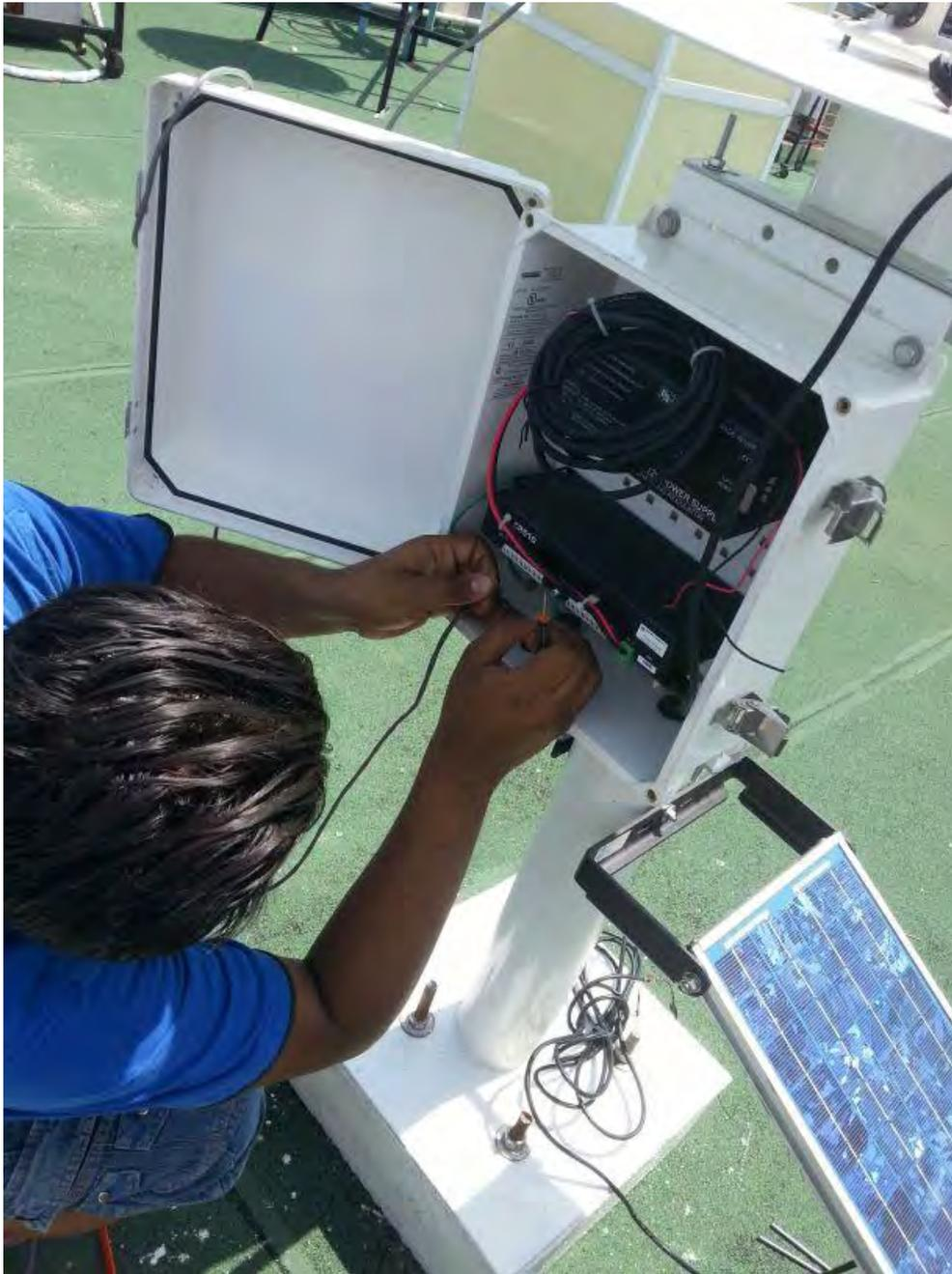
Figura 33. Foto de armado del sistema de adquisición con el modulo fotovoltaico para su carga.
