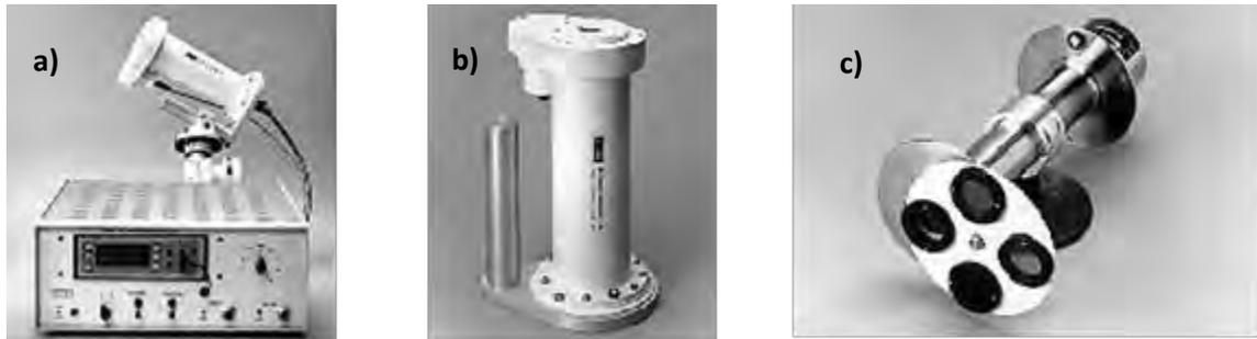
Figura 12. Accesorios del pirheliómetro: a) receptor de señal. b) adquisidor de datos c) filtros solares
