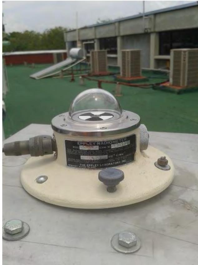
Figura 31. Foto de aseguramiento y nivelación de los piranómetros.
