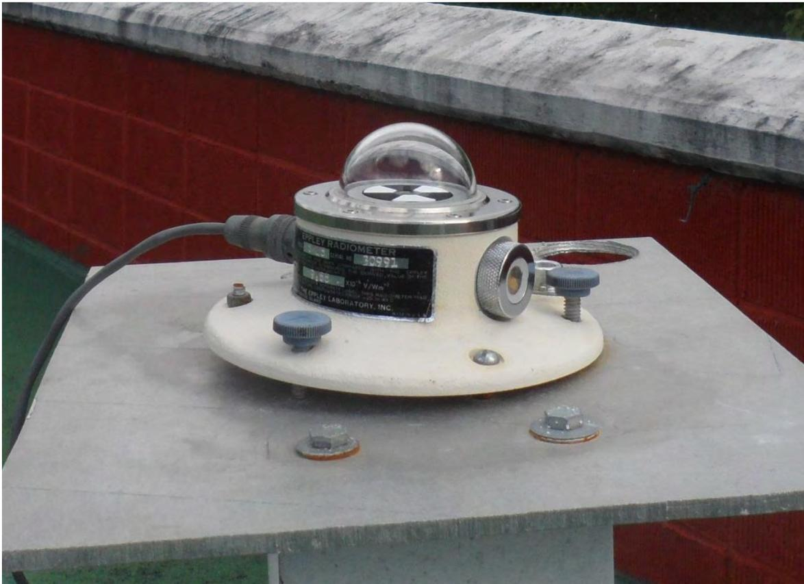
Figura 21. Fotografía de Piranómetro para la medición de la radiación solar global
