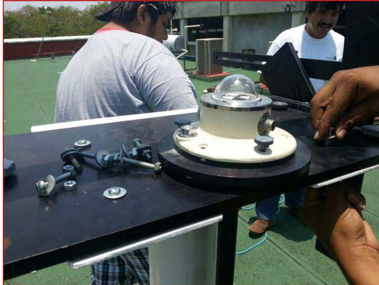
Figura30. Foto de aseguramiento de la banda Sombreadora con tornillos y tuercas.
