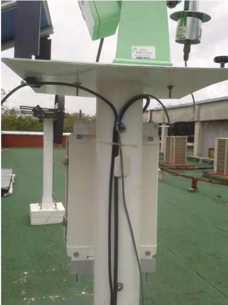
Figura 32. Foto de conexión de los dispositivos de medición a la unidad de adquisición.
