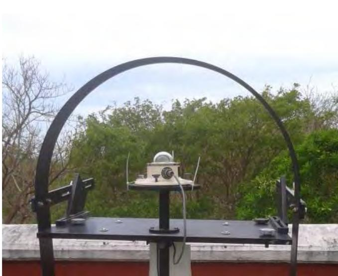
Figura 10. Fotografía de Piranómetro con banda sombreadora.
