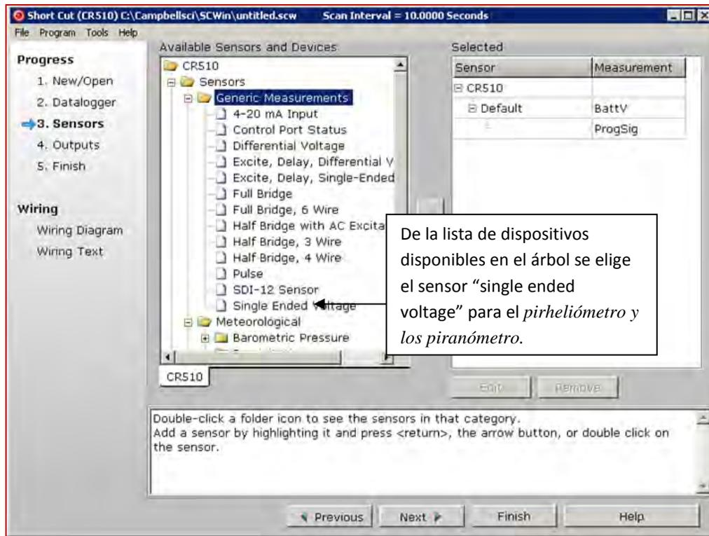
Figura 3: pantalla para seleccionar los tipos de sensores en el sistema.
