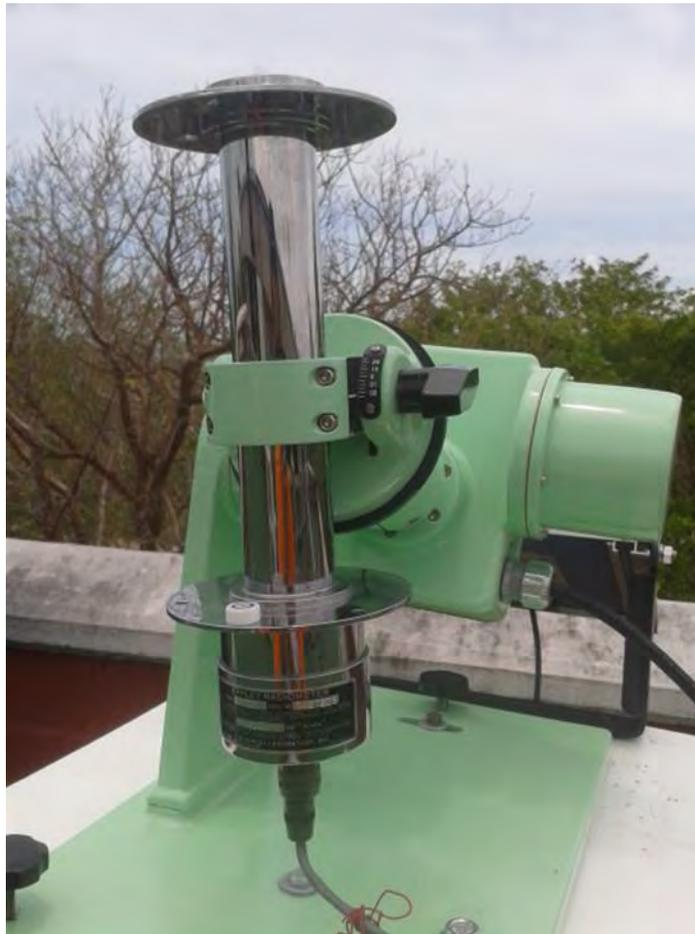
Figura 23. Fotografía de Pirheliómetro para la medición de la radiación solar Directa
