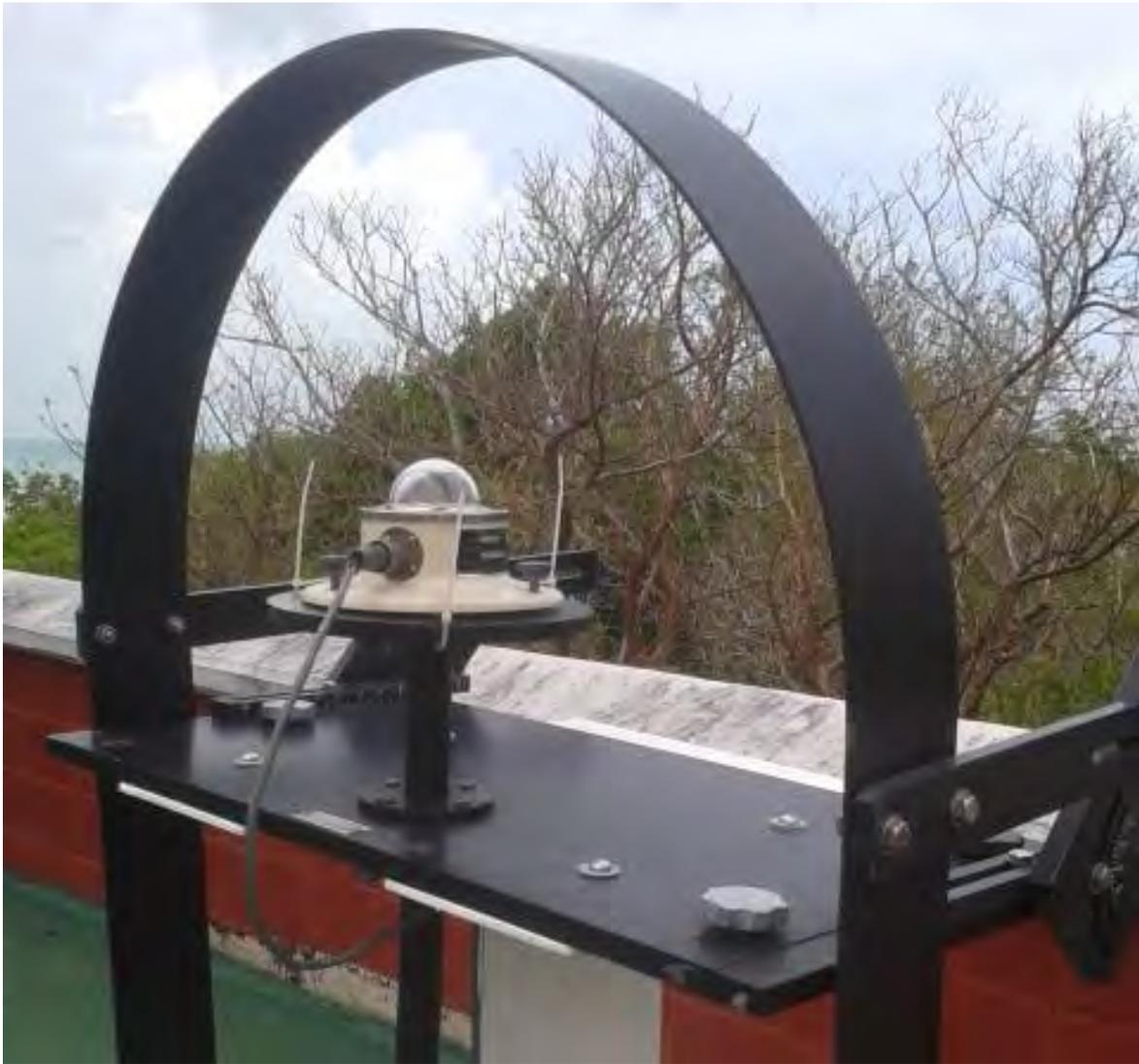
Figura 22. Fotografía de Piranómetro con banda sombreadora para la medición de la radiación solar Difusa.
