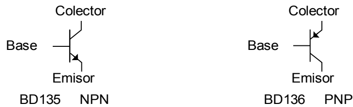
Figura 48. Esquema de los transistores pnp y npn utilizados para amplificar la corriente.
