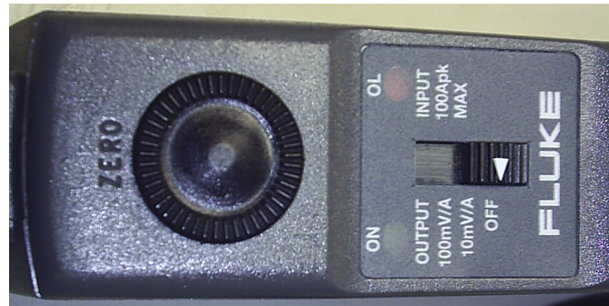
Figura 71. Fotografía en la que se observa el interruptor de encendido y ajuste de cero de la punta amperimétrica (tomada por Fco. Núñez).
