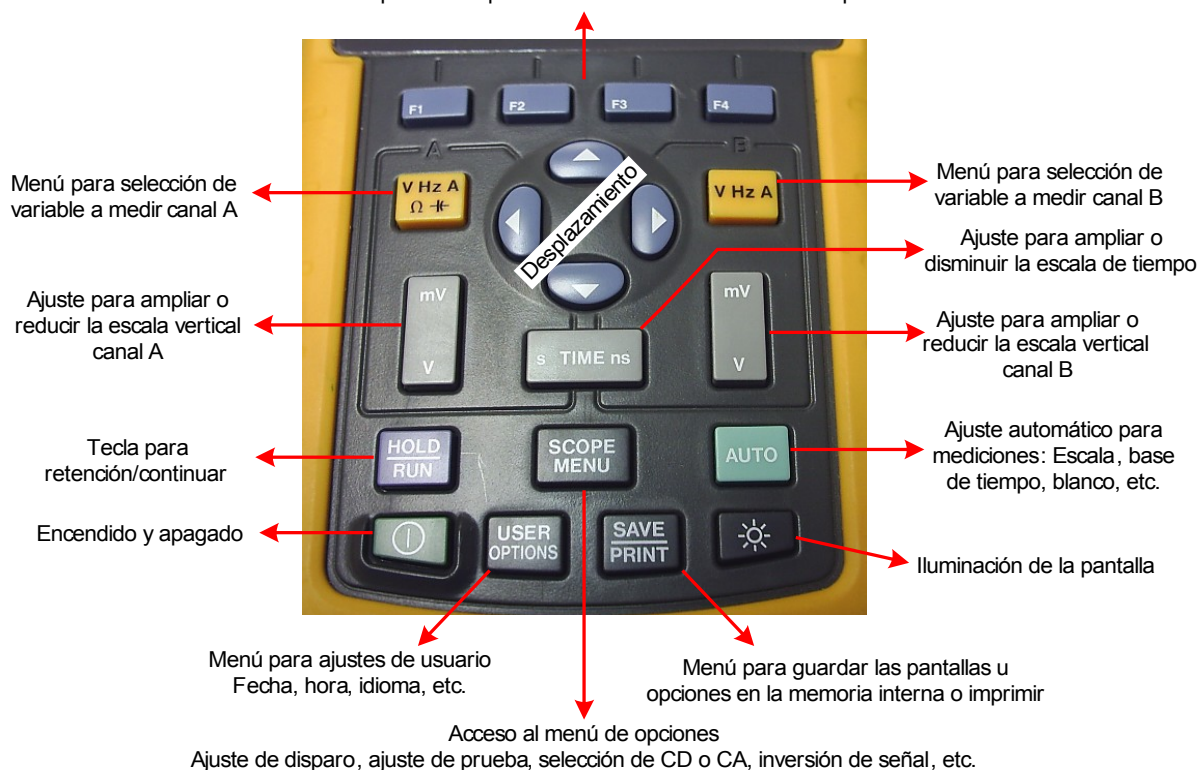
Figura 63. Fotografía con la descripción de los botones de operación del Scopemeter (tomada por Fco. Núñez).
