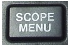
Figura 68. Fotografía de la tecla para abrir el menú del Scopemeter.
