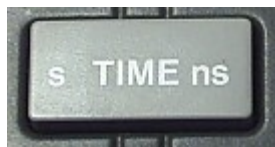
Figura 67. Fotografía de la tecla de ajuste de la base de tiempo. Al presionar s aumenta la base de tiempo y al presionar ns disminuye.
