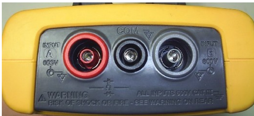
Figura 64. Fotografía de las terminales de conexión del Scopemeter. De izquierda a derecha se tiene la terminal del canal A, la terminal Común y la terminal del canal B (tomada por Fco. Núñez).
