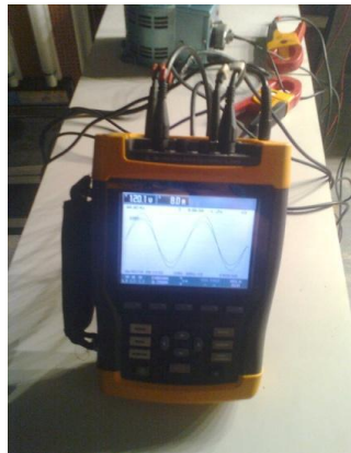
Figura. 2.7.-Equipo para medir la calidad de la energía eléctrica
