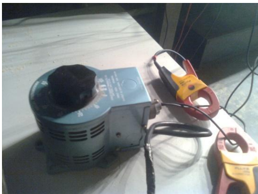
Figura 2.5.-Fotografía del autotransformador empleado como fuente.
